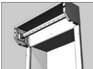
Вариант монтажа роллеты с пружинно-инерционным механизмом Отверстие для вывода элементов управления не нужно.
