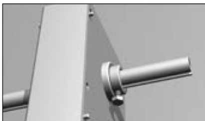
Закрепите стопорные кольца на валу болтами М8×25 мм (болты должны упираться в шпоночный паз).
